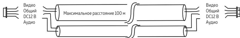
Рис. 6 Комбинированный видеокабель для подключения видеодомофона
