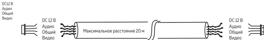
Рис. 7 Витая пара для подключения видеодомофона
