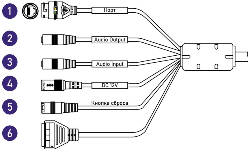
Рис. 13. Подключение кабелей
