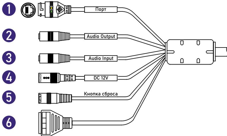
Рис. 1. Подключение кабелей
