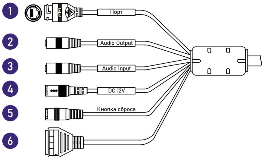
Рис. 7. Подключение кабелей
