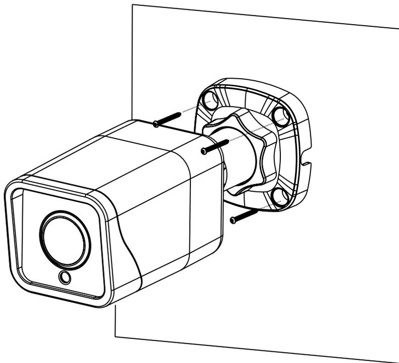
Рис. 11. Монтаж камеры
