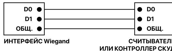
Рис. 4 Подключение RFID считывателя или контроллера СКУД
