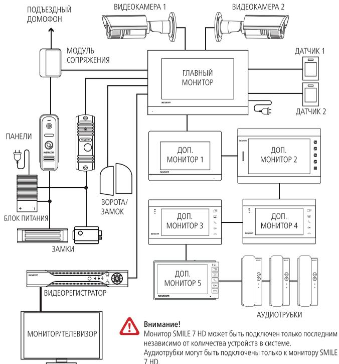
Рис. 6 Функциональная схема системы на базе видеодомофонов HD серии
