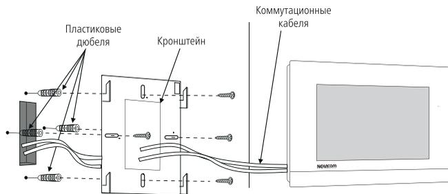
Рис. 4 Монтаж видеодомофона
