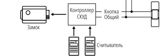
Схема подключения вызывной панели LEGEND к контроллеру СКУД
