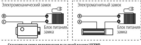
Стандартная схема подключения вызывной панели LEGEND
