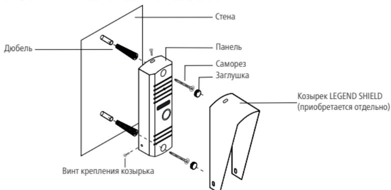
Рис. 8 Фронтальная установка вызывной панели.
