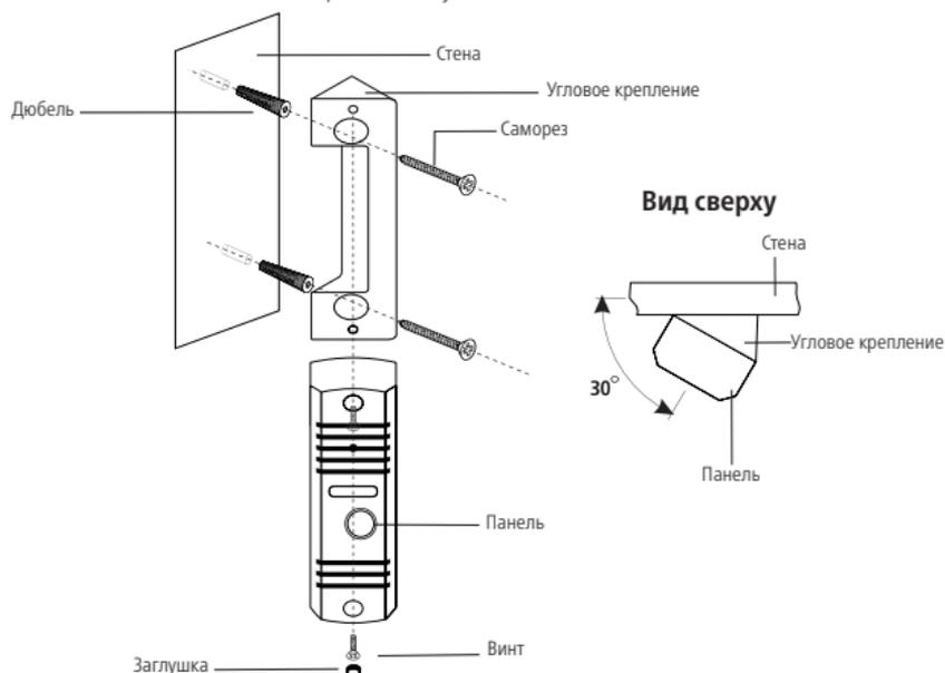
Рис. 9 Установка вызывной панели под углом 30°.
