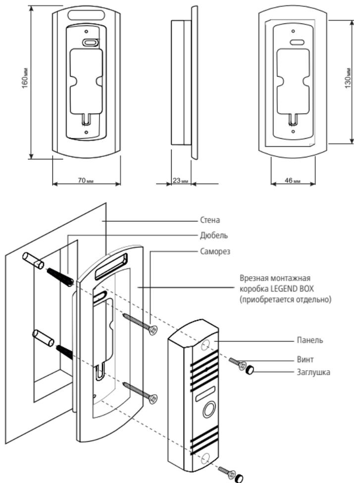
Рис. 10 Врезной монтаж вызывной панели
