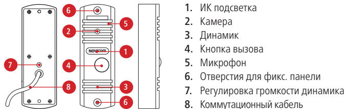
Рис. 7 Вызывная панель, входящая в комплект SMILE 4/7 KIT
