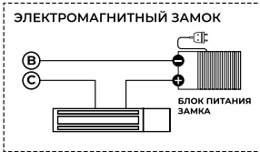
Рис.2 Подключение блока питания и замка
