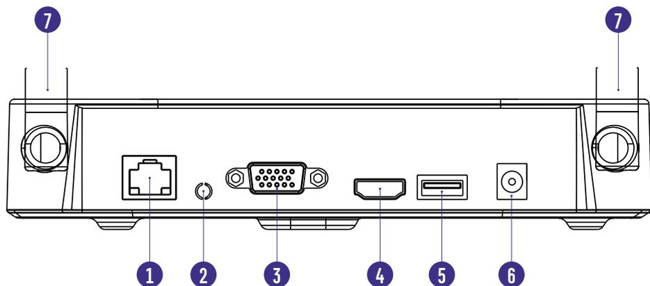
Рис.4 Интерфейсы подключения регистратора
