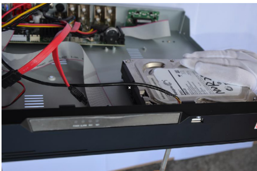
Рис. 11. Установка жесткого диска
