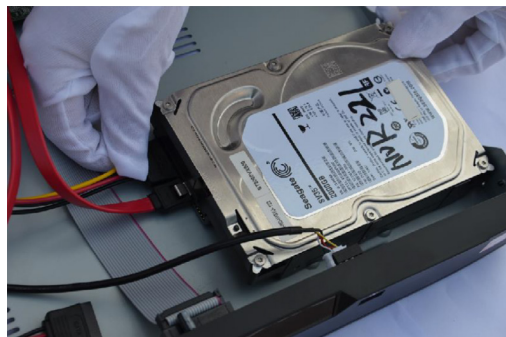
Рис. 12. Установка жесткого диска
