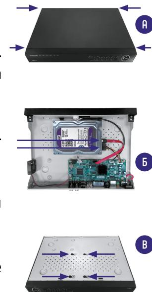
Рис. 3 Установка жесткого диска
