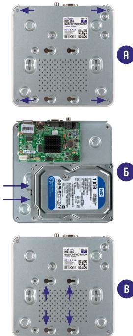
Рис. 2 Установка жесткого диска
