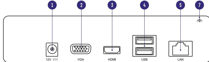
Рис. 5 Пример интерфейса задней панели NR1604 | NR1608
