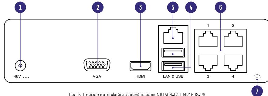
Рис. 6 Пример интерфейса задней панели NR1604-P4 | NR1608-P8
