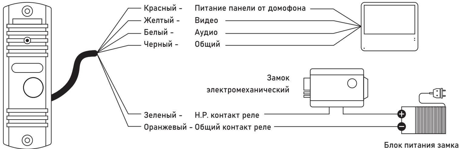
Рис. 8 Схема подключения вызывной панели к домофону и электромеханическому замку
