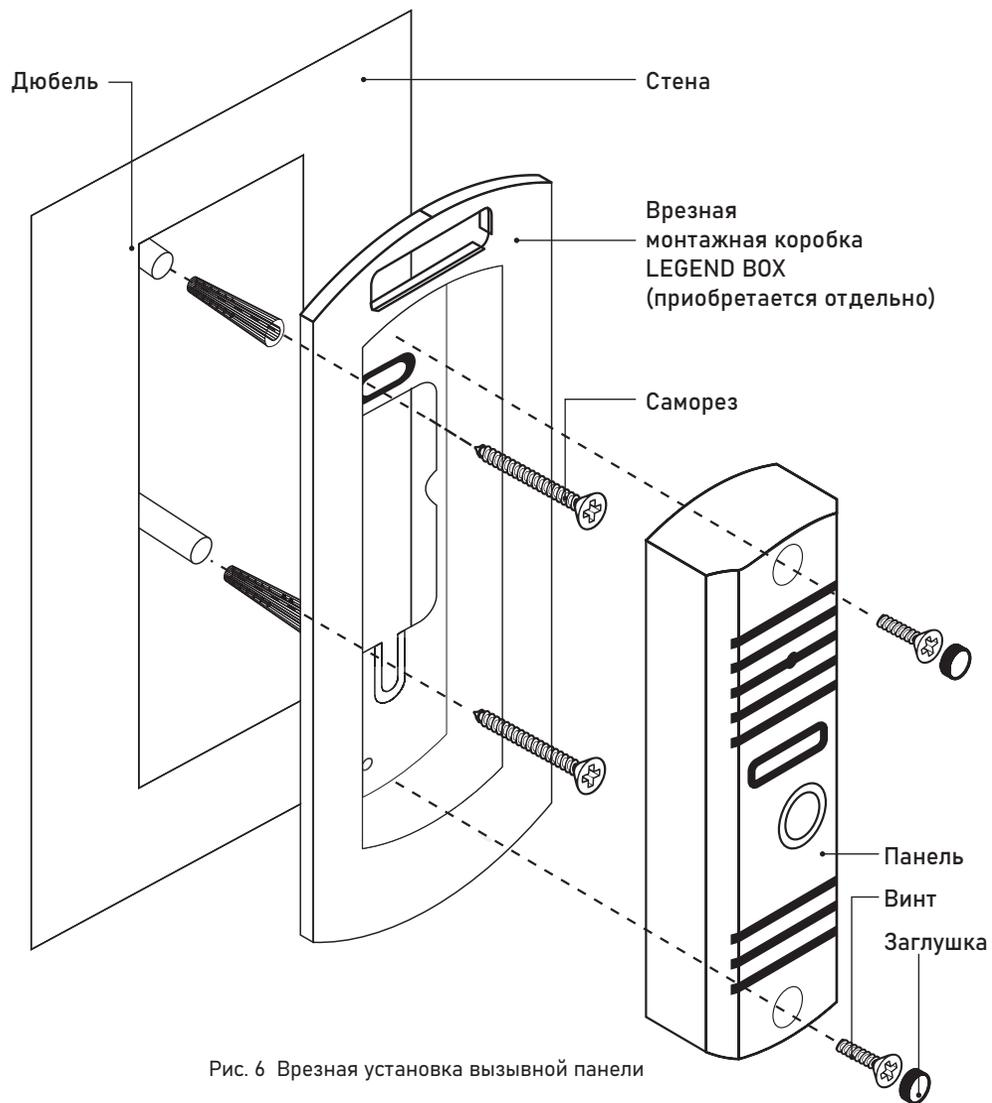
Рис. 6 Врезная установка вызывной панели
