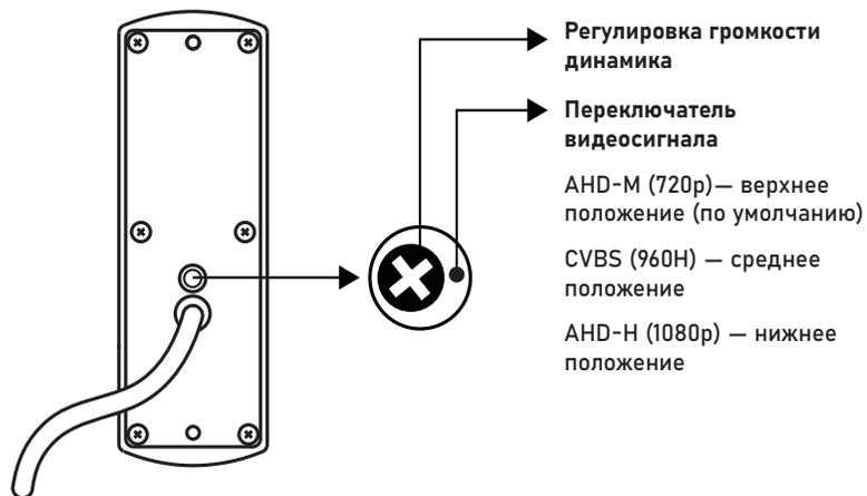
Рис. 7 Регулировка громкости звука и переключение режимов
