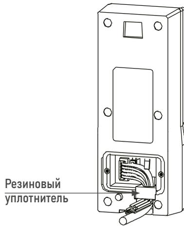
Рис. 5 Подключение и укладка коммутационных кабелей
