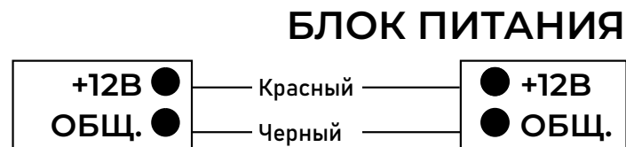
Рис. 8 Подключение внешнего блока питания
